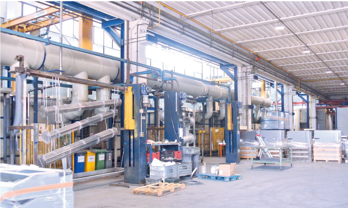
2 – Il grande impianto per il decapaggio dell'acciaio inox e altri metalli (come il titanio): nel passato è stato utilizzato anche con la tecnologia di autoforesi, tecnologia dismessa qualche tempo fa, ma che Leonardo Innocenti ritiene valida perché ad immersione. È alla ricerca di tecnologie alternative per aumentare
